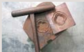
銅板のもようは、職人が木型をつくり、木づちでたたいてつくっていた。
