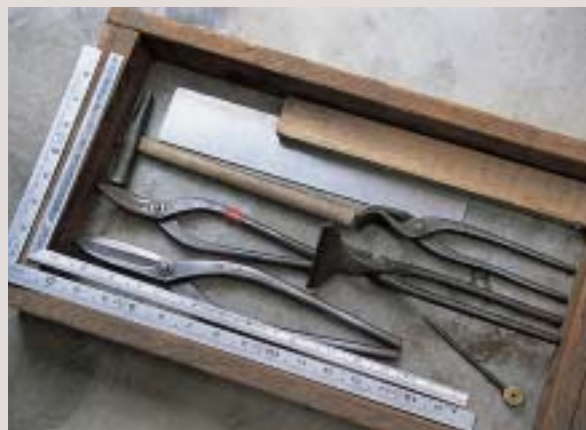
左下から「さしがね」「まども」「けやき針」「つかみ」「柳刀（やなぎば）」「金槌」「やっこ」「かたな刃」「ひょうし木」。つかみ・金槌・柳刀の三丁道具があればほとんどの仕事ができるため、軒下での作業には必ず持って行けといわれる、いわば板金屋の命。
